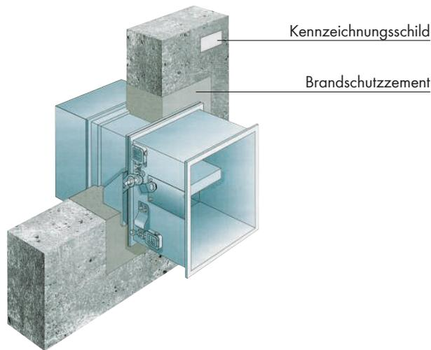
**Abschottungssystem aus Spezialmörtel für Decken- und Wanddurchführungen von Feuerschutzklappen.**
